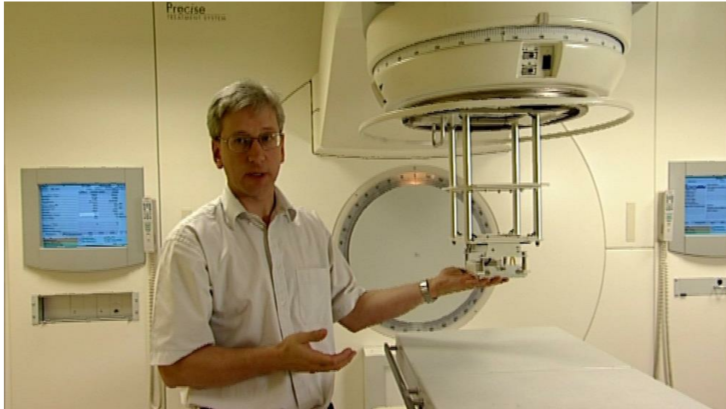
Placement de l'applicateur des électrons pour l'accélérateur linéaire
